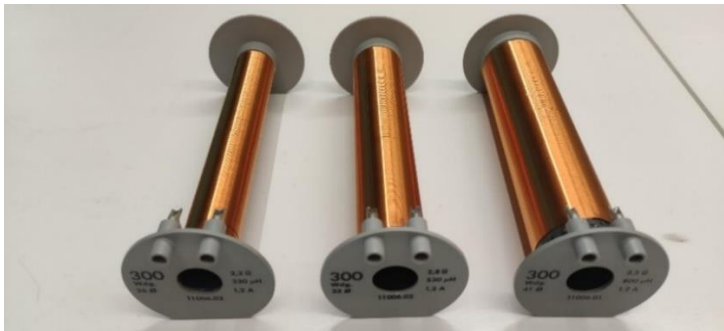
Abbildung 33: Spulen mit unterschiedlichen Durchmessern (Eigene Abbildung)
