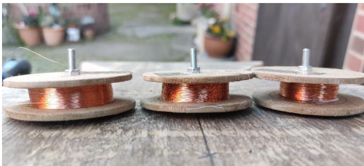
Abbildung 72: Ungleichmäßig gefüllte Spulen (Eigene Abbildung)
