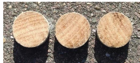
Abbildung 67: Holzkerne der Spulen (Eigene Abbildung)
