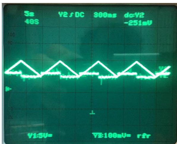
Abbildung 40: Messverlauf bei einer Spule: 75 Wdg.; 26 mm Durchmesser; 0,15 \Omega ; 24 \mu\text{H} ; 4 A (Eigene Abbildung)
