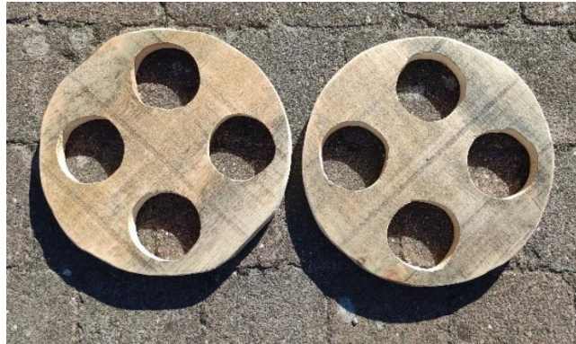
Abbildung 55: Rotorplatten mit ausgeschnittenen Löchern (Eigene Abbildung)
