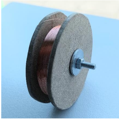
Abbildung 74: Fertige Spule (Eigene Abbildung)
