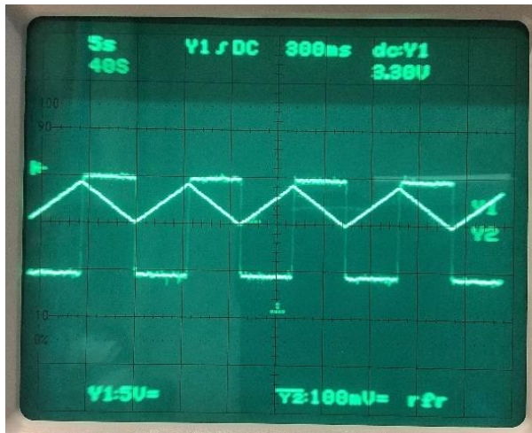
Abbildung 38: Messverlauf bei einer Spule: 300 Wdg.; 41 mm Durchmesser; 3,5 \Omega ; 800 \mu H; 1,2 A (Eigene Abbildung)
