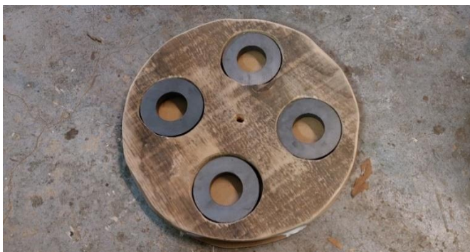
Abbildung 59: Eingesetzte Ringmagneten (Eigene Abbildung)
