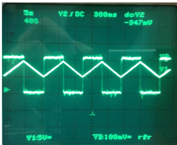
Abbildung 46: Messverlauf bei einer Spule: 300 Wdg.; 41 mm Durchmesser; 3,5 Ω; 800 μH; 1,2 A; 16,2 cm Länge (Eigene Abbildung)
