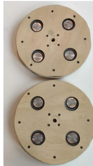
Abbildung 86: Rotorplatten mit Eisenkernen (Eigene Abbildung)
