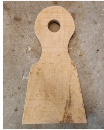
Abbildung 64: Ständer mit Loch für das Kugellager (Eigene Abbildung)
