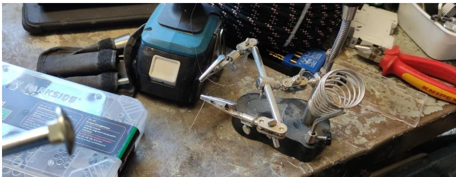
Abbildung 73: Verlöten der Drahtenden (Eigene Abbildung)
