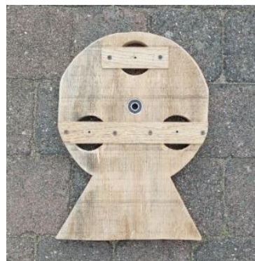
Abbildung 62: Stator ohne Spulen (Eigene Abbildung)
