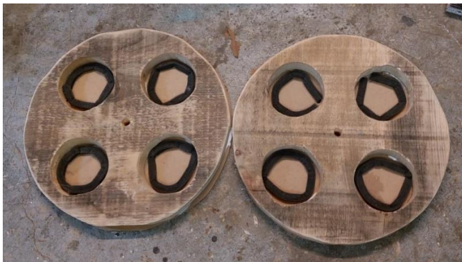
Abbildung 58: Rotorplatten mit Polsterung (Eigene Abbildung)
