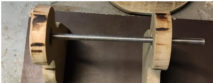
Abbildung 65: Eingehängte Achse (Eigene Abbildung)
