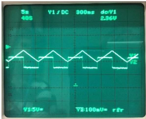
Abbildung 36: Messverlauf bei einer Spule: 300 Wdg.; 26 mm Durchmesser; 2,2 \Omega ; 330 \mu\text{H} ; 1,2 A (Eigene Abbildung)
