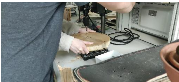
Abbildung 88: Bohren von Löchern an den Rückseiten der Rotorplatten (Eigene Abbildung)
