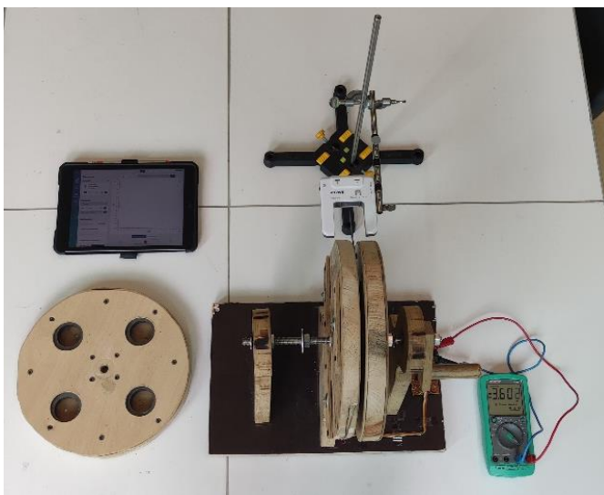
Abbildung 89: Versuchsaufbau: Messung der Spannung und Stromstärke bei Rotorplatten mit und ohne Eisenkerne (Eigene Abbildung)
