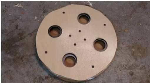
Abbildung 60: Fertige Rotorplatte ohne Eisenkerne (Eigene Abbildung)
