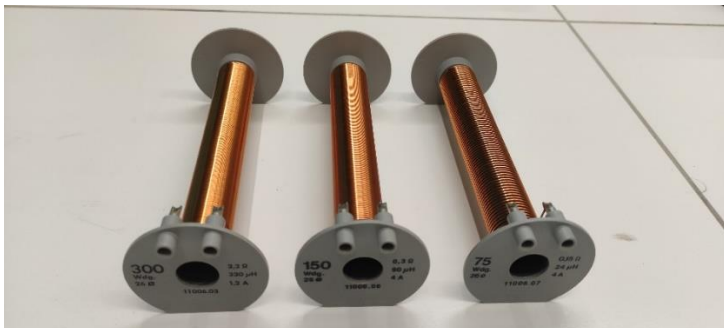
Abbildung 34: Spulen mit unterschiedlichen Windungszahlen (Eigene Abbildung)
