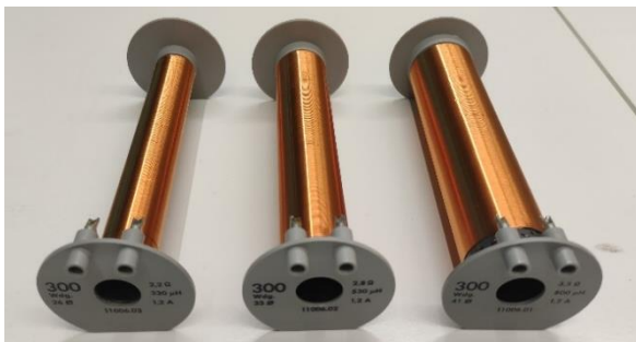
Abbildung 19: Spulen mit unterschiedlichem Durchmesser (Eigenaufnahmen 2022-2023)
