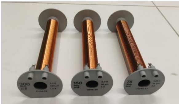
Abbildung 18: Spulen mit unterschiedlichen Windungszahlen (Eigenaufnahmen 2022-2023)
