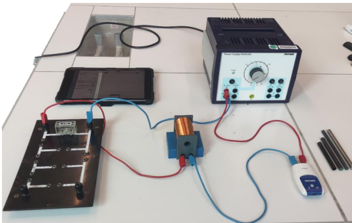
Abbildung 36: Erforschung der Induktivität durch verschiedene Kerne in einer Spule: Aufbau (Eigenaufnahmen 2022-2023)
