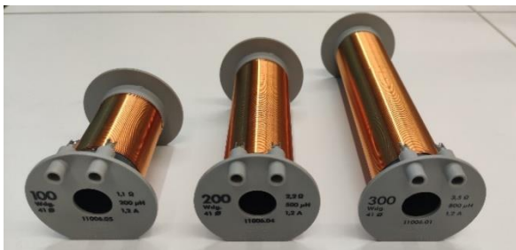
Abbildung 20: Spulen mit unterschiedlichen Längen (Eigenaufnahmen 2022-2023)
