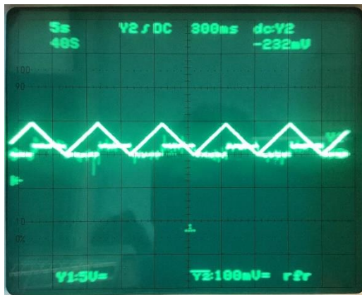
Abbildung 23: 75 Windungen, 26mm Durchmesser, 0,15Q, 24yH, 4A (Eigenaufnahmen 2022-2023)
