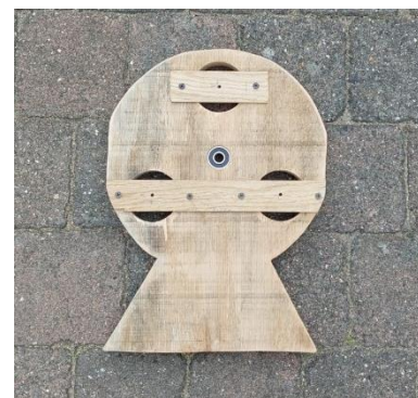
Abbildung 61: Stator mit Löchern, Kugellager und Holzplatten zur Befestigung der Spulen auf einer Seite
