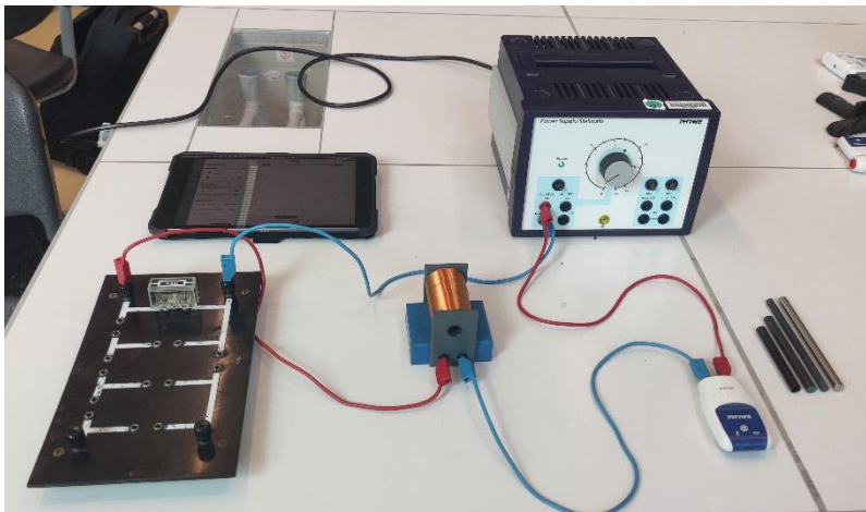
Abbildung 39: Aufbau des Induktivität Experiments
