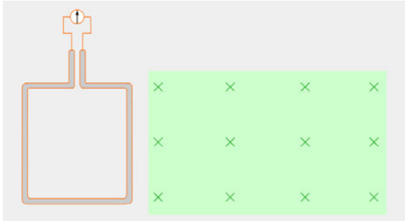
Abbildung 6: Leiterschleife außerhalb des Magnetfeldes
