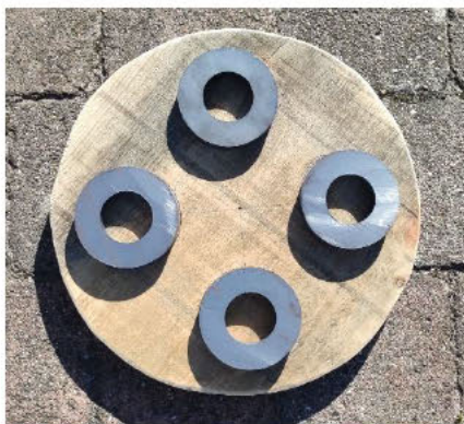
Abbildung 45: Ringmagneten auf den Rotorplatten, Vorgang der Abzeichnung
