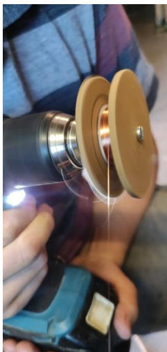
Abbildung 57: Aufwicklungsvorgang der Spulen
