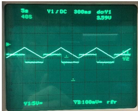
Abbildung 31: 300 Windungen, 26mm Durchmesser, 2,2Q, 330yH, 1,2A
